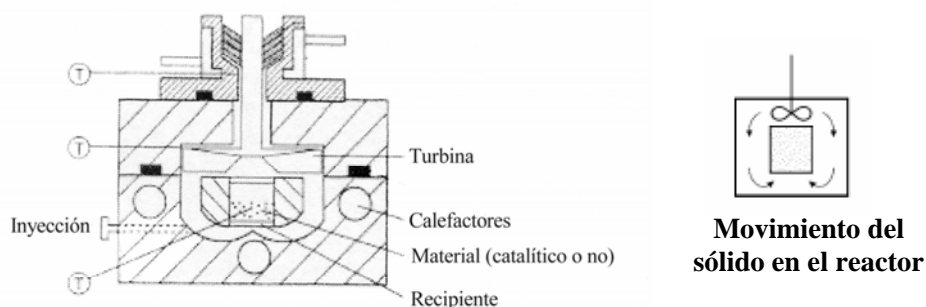
Figura 19. Diagrama esquemático de un reactor "riser" (a escala de laboratorio).
